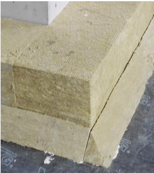
Abbildung 12. Beispiel Mineralwolle, hier Steinwolle (Foto: dena, Schirmer)
