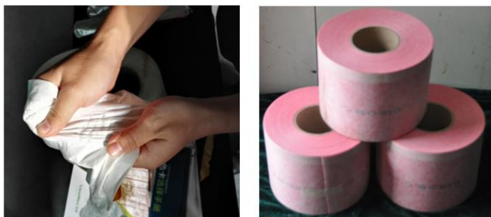
Abbildung 24. Zerreißtest schlechtes Band, Dichtbänder Bosig, Foto dena, Schirmer
