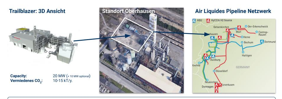
erstes Projekt, bei dem erneuerbarer Wasserstoff/Sauerstoff in ein bestehendes Pipelinenetz eingespeist wird.
