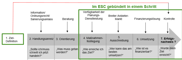
Abb. 3: ESC bündelt die einzelnen Handlungsschritte eines Sanierungsvorhabens und spart so Zeit und Kosten
