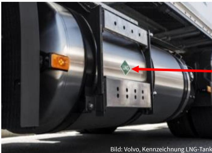
Bild: Volvo, Kennzeichnung LNG-Tank
