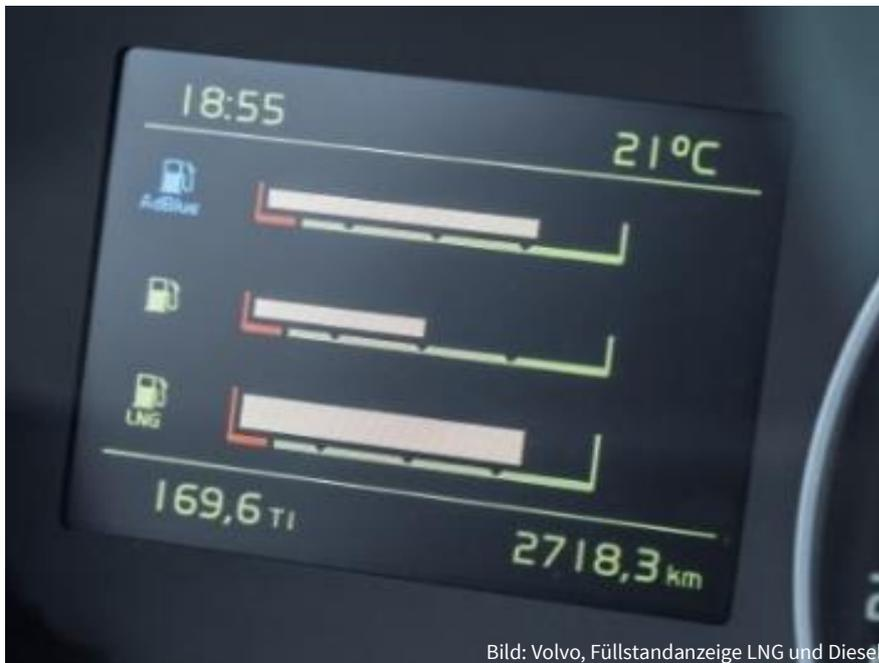
Bild: Volvo, Füllstandanzeige LNG und Diesel
